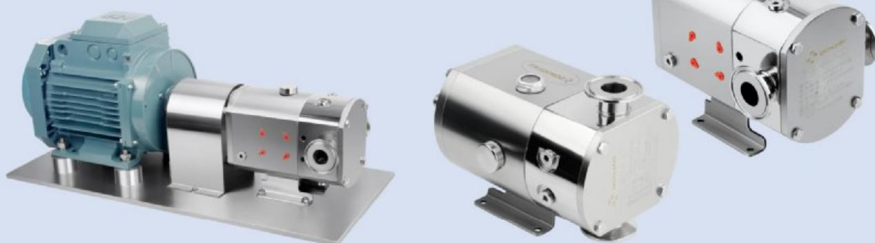
MINI STU-10 转子泵是一款迷你型位移凸轮转子泵，它对于高粘度和低粘度的物料输送具有广泛的应用。该泵具有体积小，噪音低、转速范围广、维护简单且经济，全不锈钢外壳(包含齿轮箱)，内部高洁净等设计优点，全不锈钢外观设计可以满足外部冲洗的需求。该泵主要应用于如生物制药、精细化工、啤酒饮料、实验室等各种卫生要求工况环境，也可以应用到各种工业流体输送用途。
